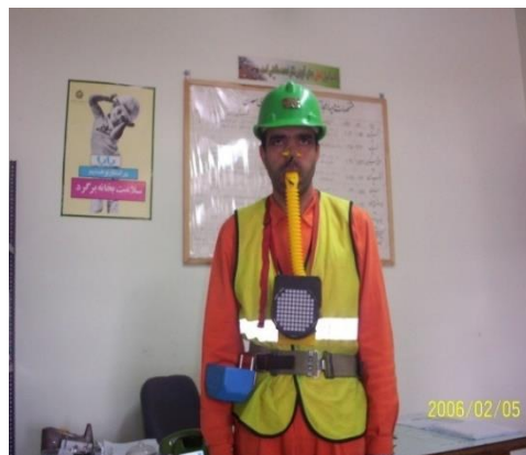
شکل ۲-۶- نمونه باز شده دستگاه خودنجات
