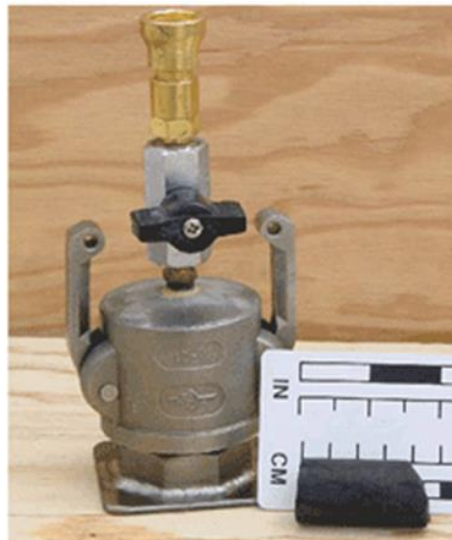
شکل ۶-۵- محفظه گازسنجی سفارشی برای نمونه های خاص
